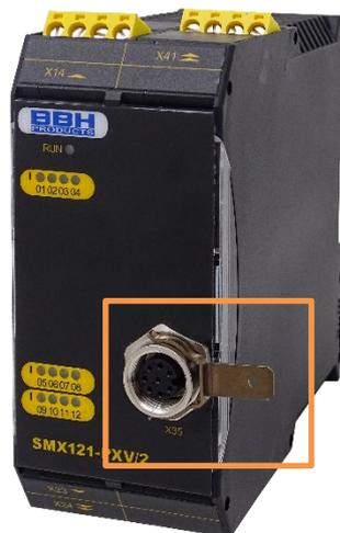
Das Abschirmen ist eine Maßnahme zur Dämpfung elektromagnetischer Störungen. Verwenden Sie bitte nur Anschlussleitungen mit Schirmgeflecht. Vermeiden Sie Anschlussleitungen mit Folienschirm.
