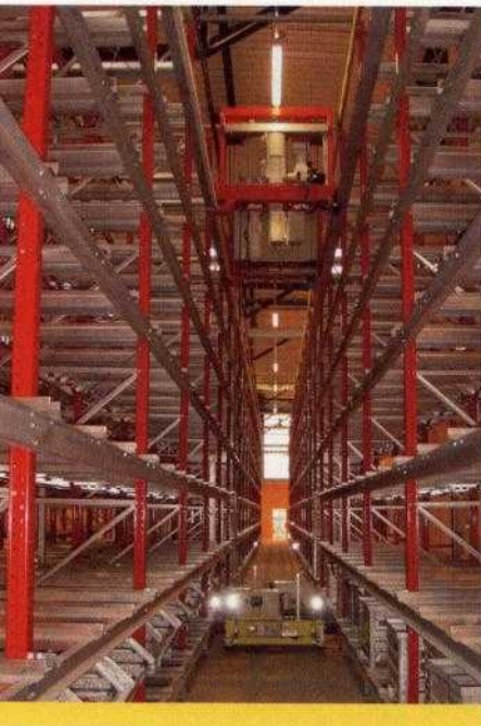
Bild 2: Modernes Hochregallager – Transfaster Technologie.
